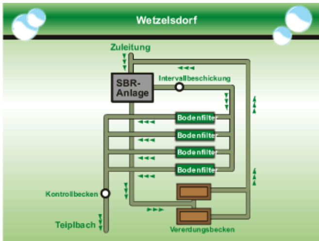
Abbildung 7: Anlagenschema Kläranlage Wetzelsdorf.
